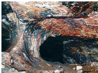
Eisenerzabbau durch Feuersetzen mehrere Antworten möglich
