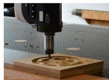
Fräse: Maschine, die Späne abfräst.
